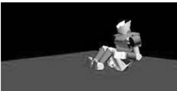
図5 転倒対応時（後方転倒）のシミュレーション
