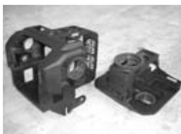
図13 胴体構造部品(鋳造)
