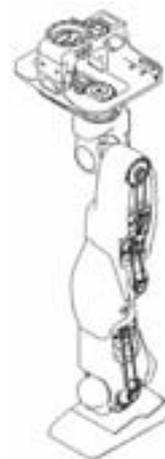
図16 脚部の構造
